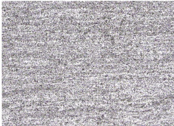
شکل (۶): ساختار منطقه ر کریستالیزه شده HAZ از فریت و پرلیت تشکیل شده است.
